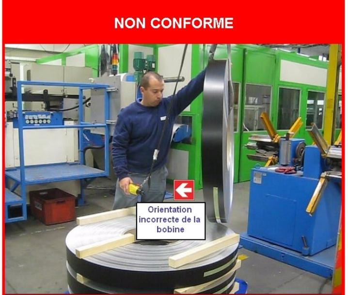
Orienter l'extrémité de languette vers la machine
